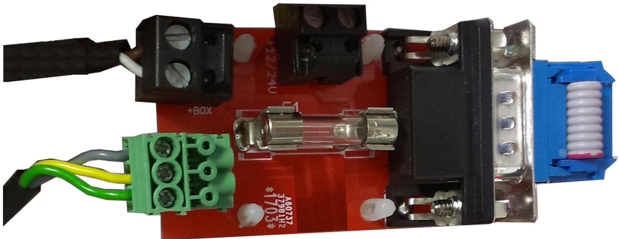
Das SM3-Modul wird anschließend direkt mit den RX und TX Pins der Zentrale verbunden und muss ebenfalls mit 12V und GND versorgt werden.
