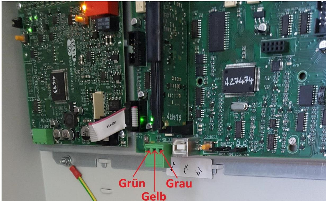
Die Stromversorgung der Box kann wahlweise über einen 12 Volt Anschluss der Zentrale oder ein externes Netzteil erfolgen.
