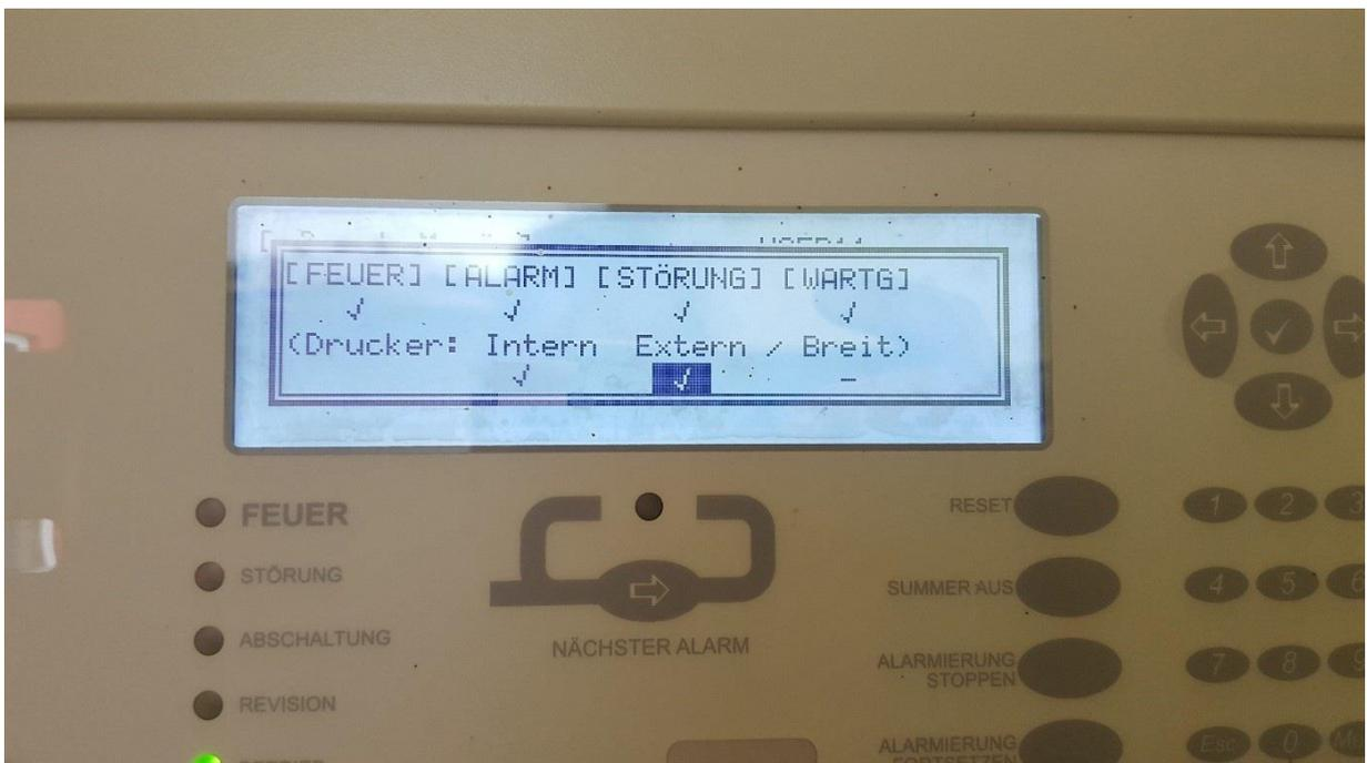
**Hinweis:** Sollte eine Druckerstörung angezeigt werden, dann wurde die Überwachung der RS232-Druckerschnittstelle (für einen externen Drucker) eingeschaltet. Dies macht nur zur Überwachung eines Druckers Sinn, jedoch nicht für die Wartungsbox. Schalten Sie den Parameter „überwachte Verbindung“ durch deaktivieren des Hakens davor ab. Sie finden diese Einstellung im ConfigTool unter der Einstellung „Drucker“.
