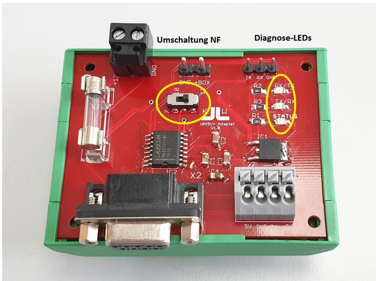
Der Adapter wird mit der Zentrale wahlweise per SUB-D Kabel (Links unten im Bild) oder mit Einzeladern (Rechts unten im Bild) verbunden.
